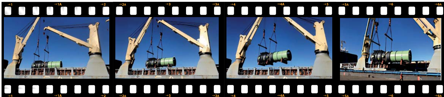
Die beiden Bordkräne der Grietje setzten den Reaktor auf den Schubleichter LD 30.
